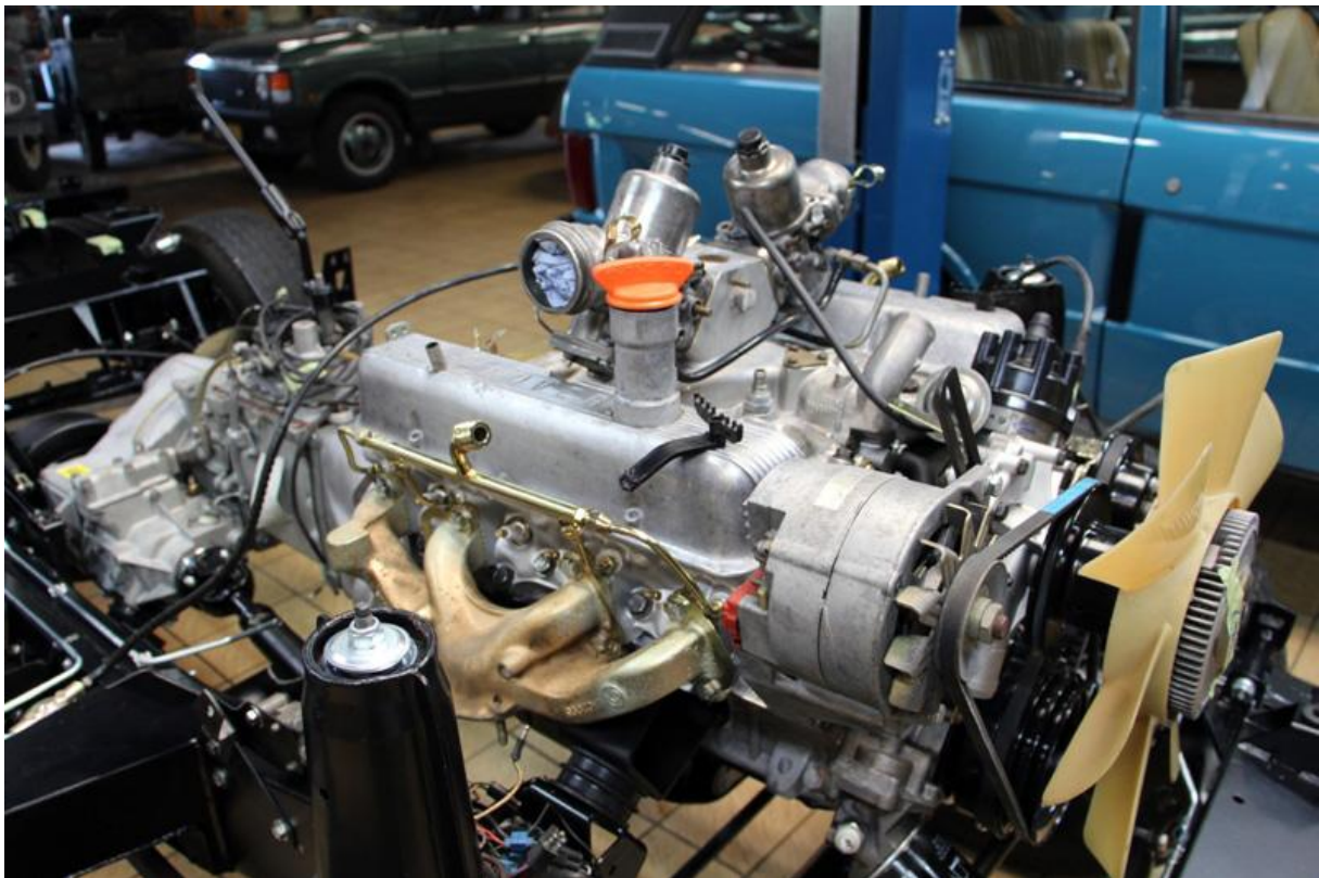
Der Motor wird wieder in den Rahmen gesetzt.
