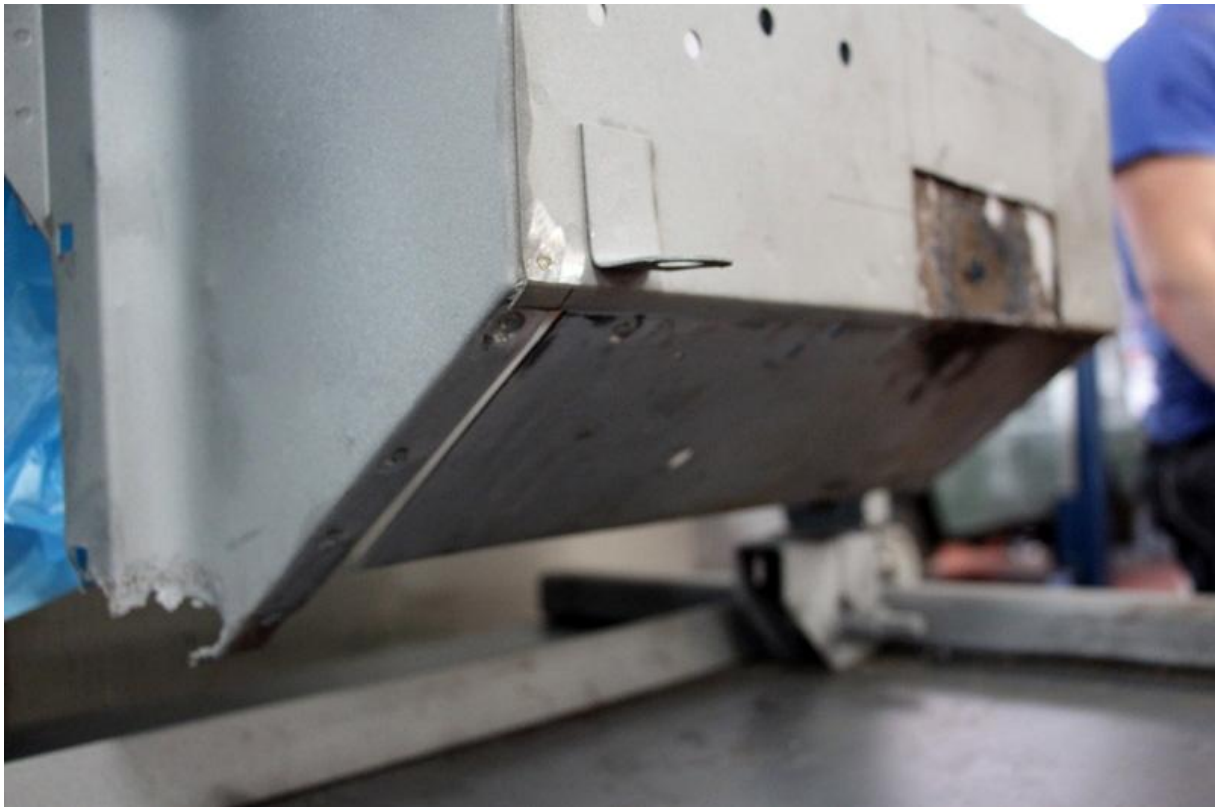
Die Spritzwand wurde gesandstrahlt, jetzt wird sie auf dem Rahmen angepasst.
