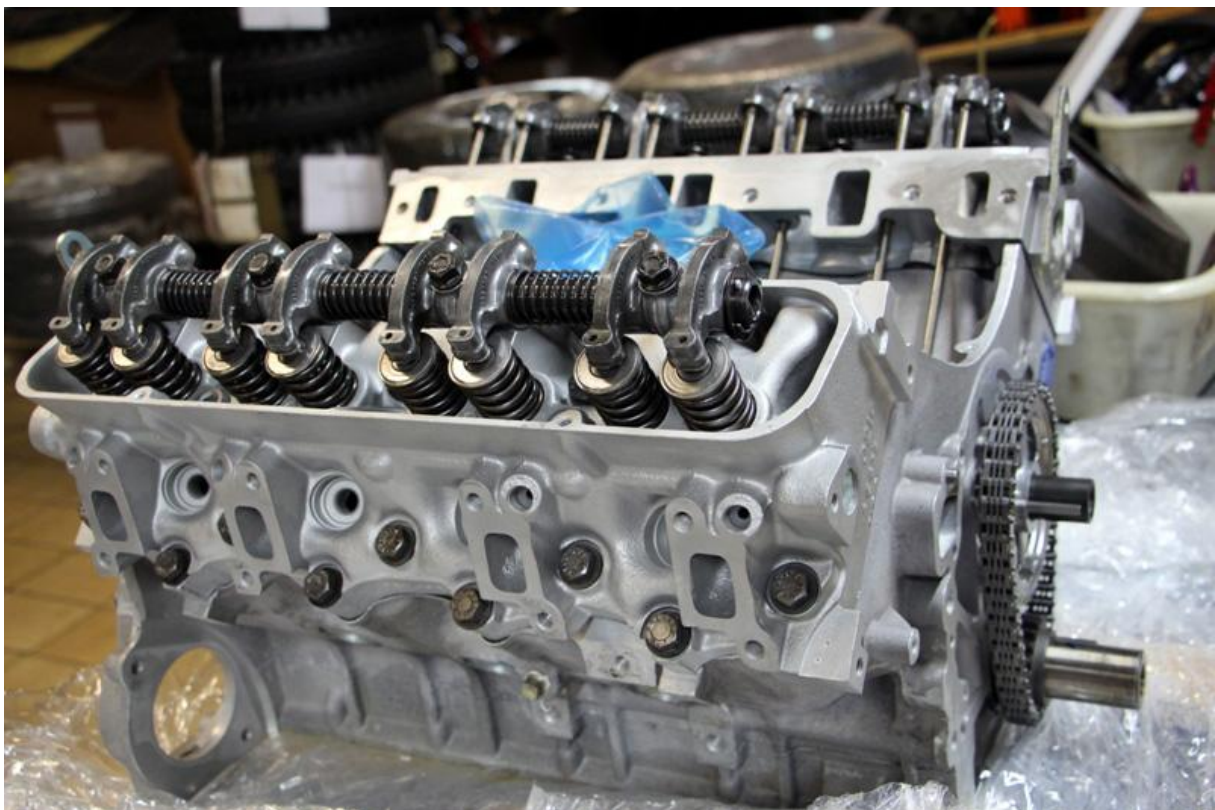
Der neue Rumpfmotor ist eingetroffen und muss nun mit allen Zusatzagregaten bestückt werden.
