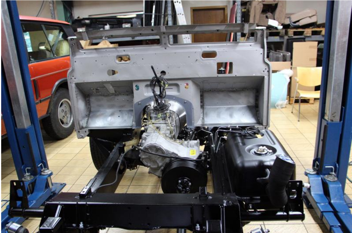
Die Spritzwand wurde gesandstrahlt, jetzt wird sie auf dem Rahmen angepasst.
