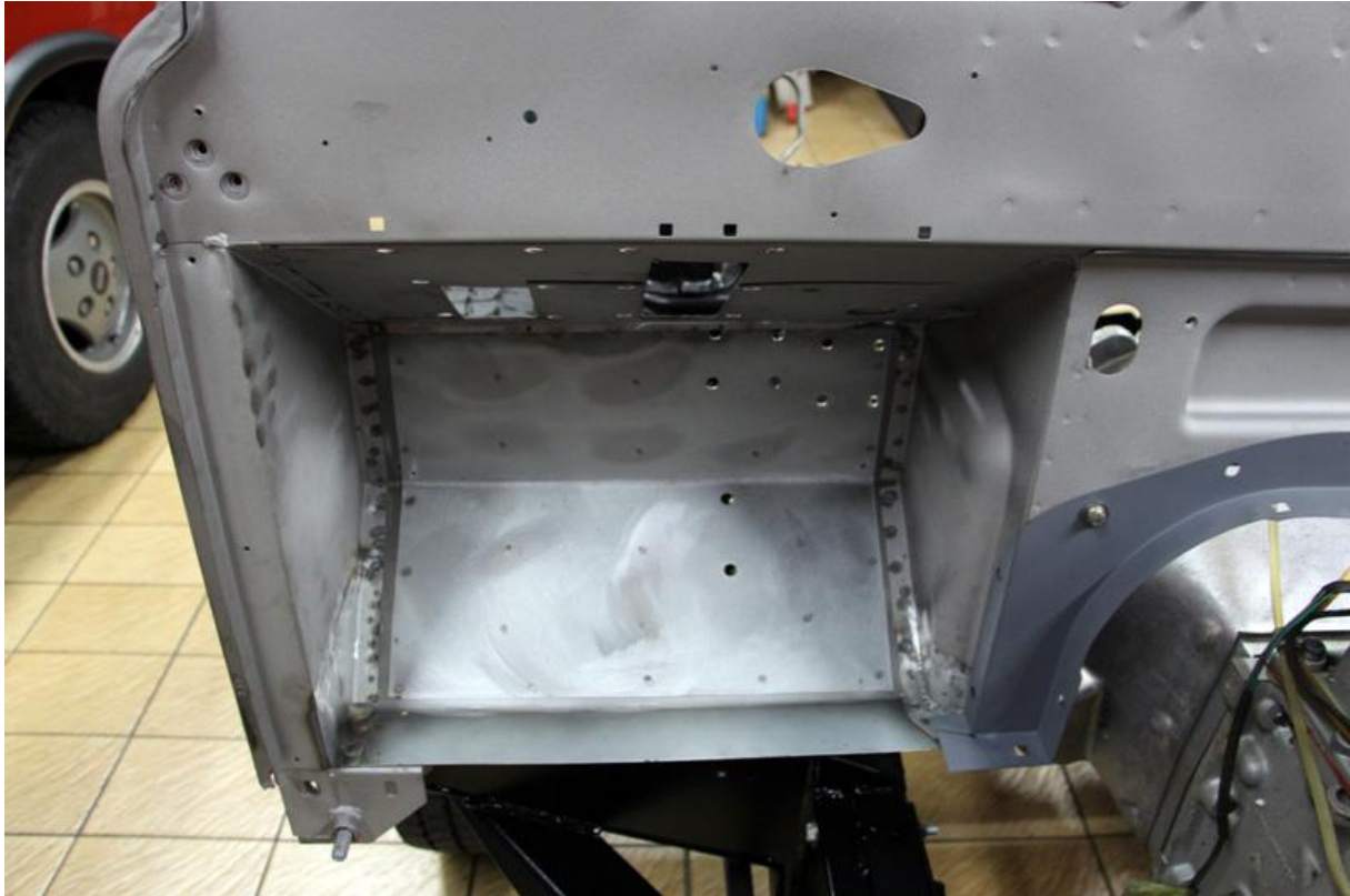
Die Fußkästen werden herausgetrennt und neu eingeschweißt.
