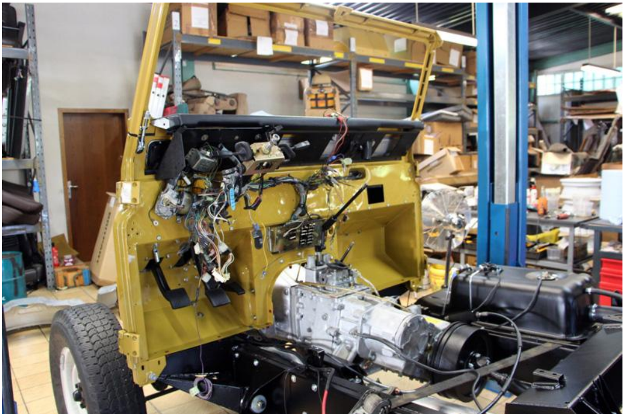
Der Kabelbaum wird installiert...
