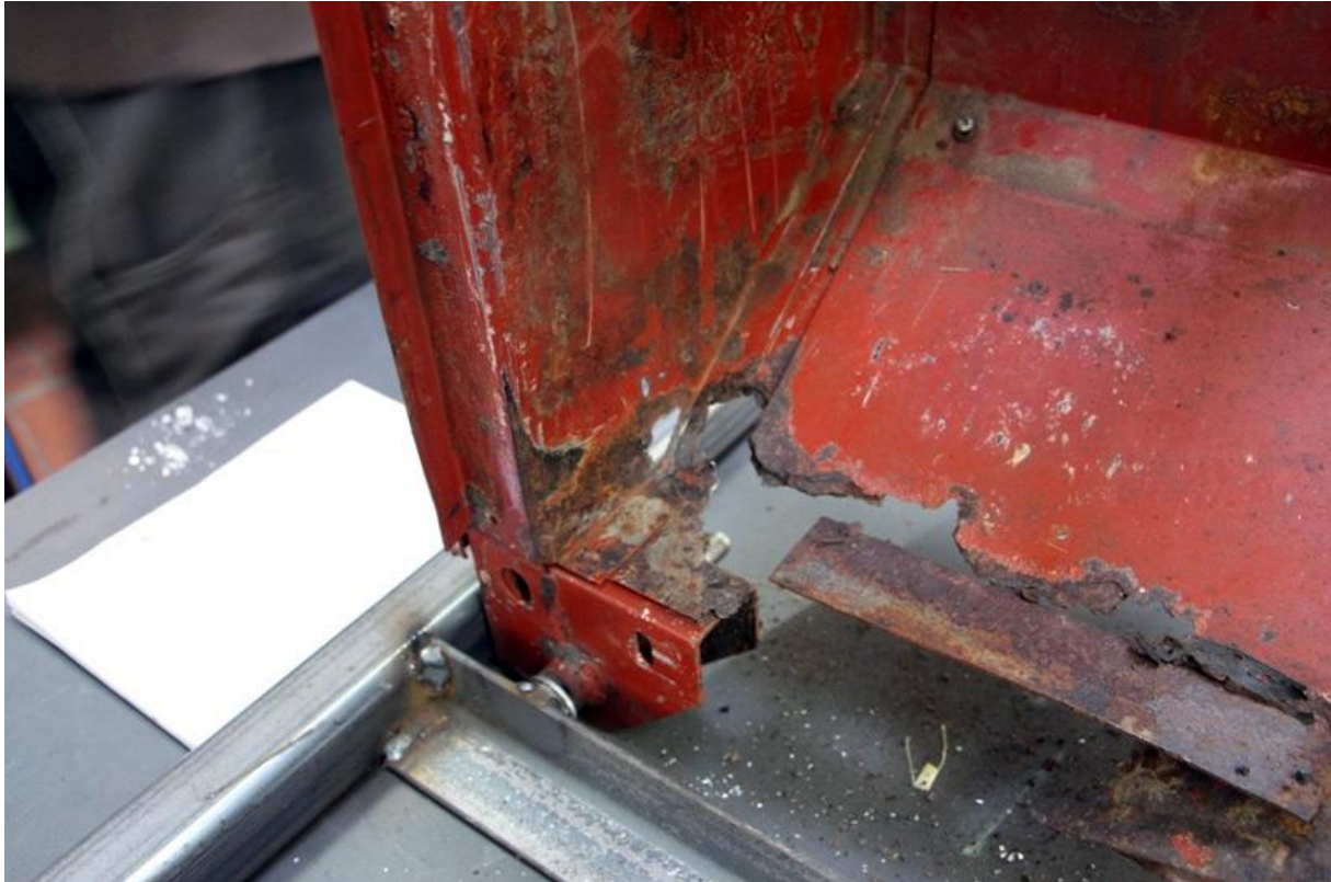
Die Unterkanten der Spritzwand sind meistens vom Rost befallen.
