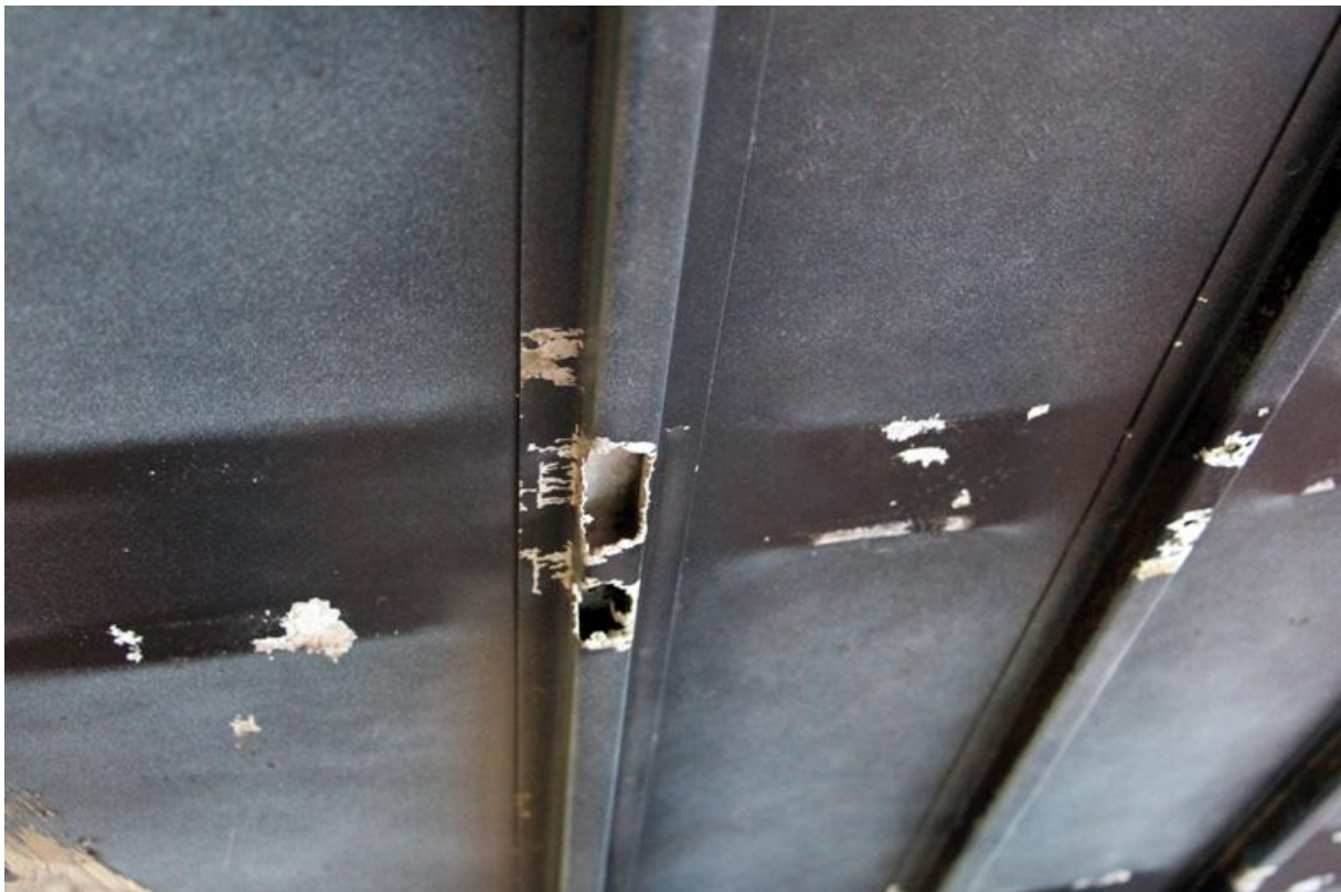
Das sind die Stellen auf die ein jeder Landrover Fahrer verzichten kann, Alukorrosion an der Heckwanne.
