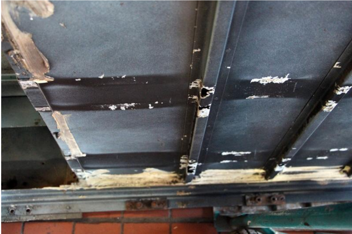
Auch am Boden der Karosse haben wir es mit Alukorrosion zu tun.
