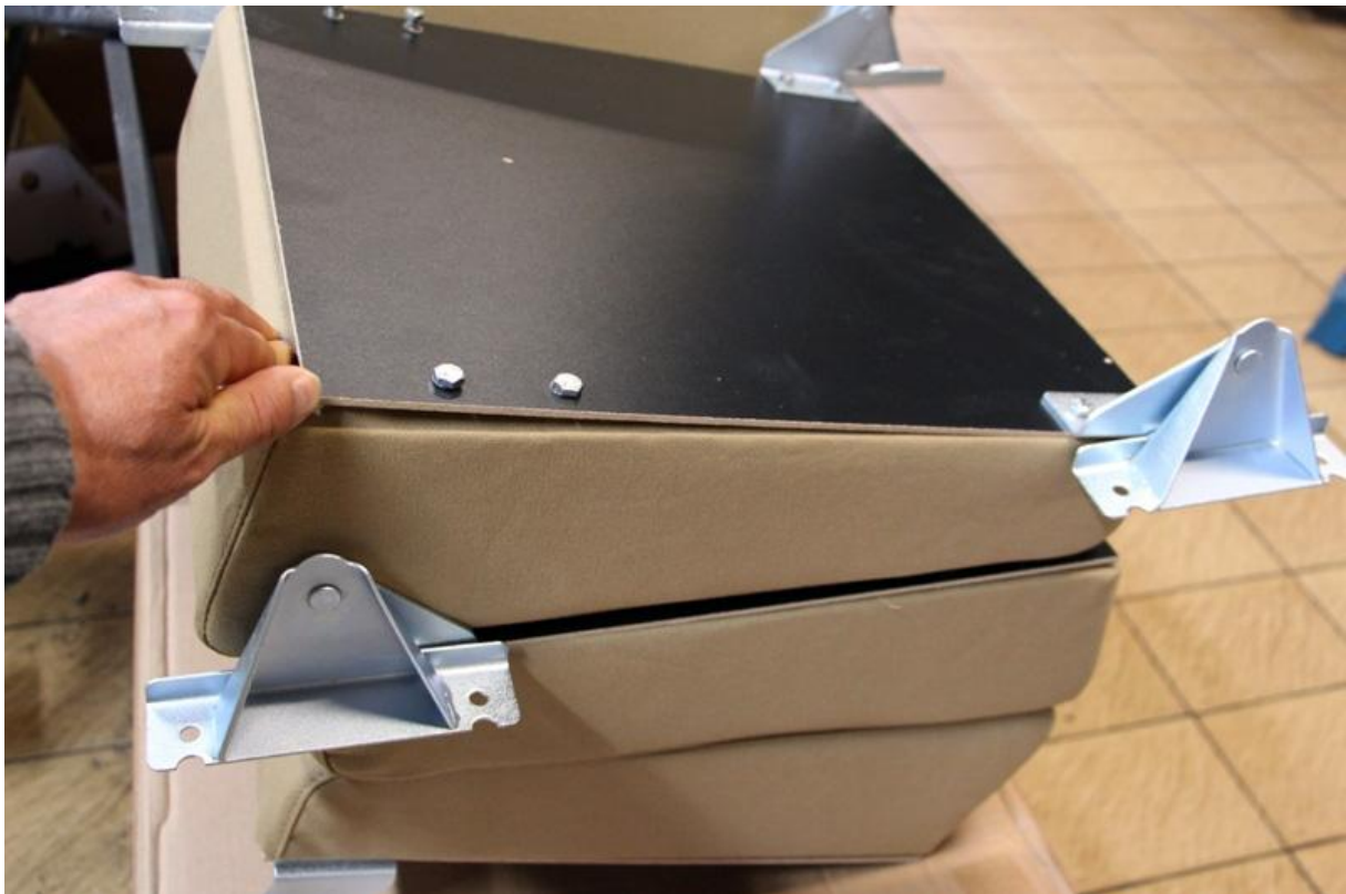
Die Anbauteile sind frisch verzinkt, die Holzteile werden überarbeitet.
