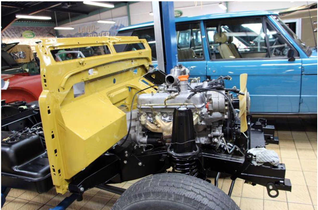
Die Spritzwand wird auf dem Rahmen montiert.
