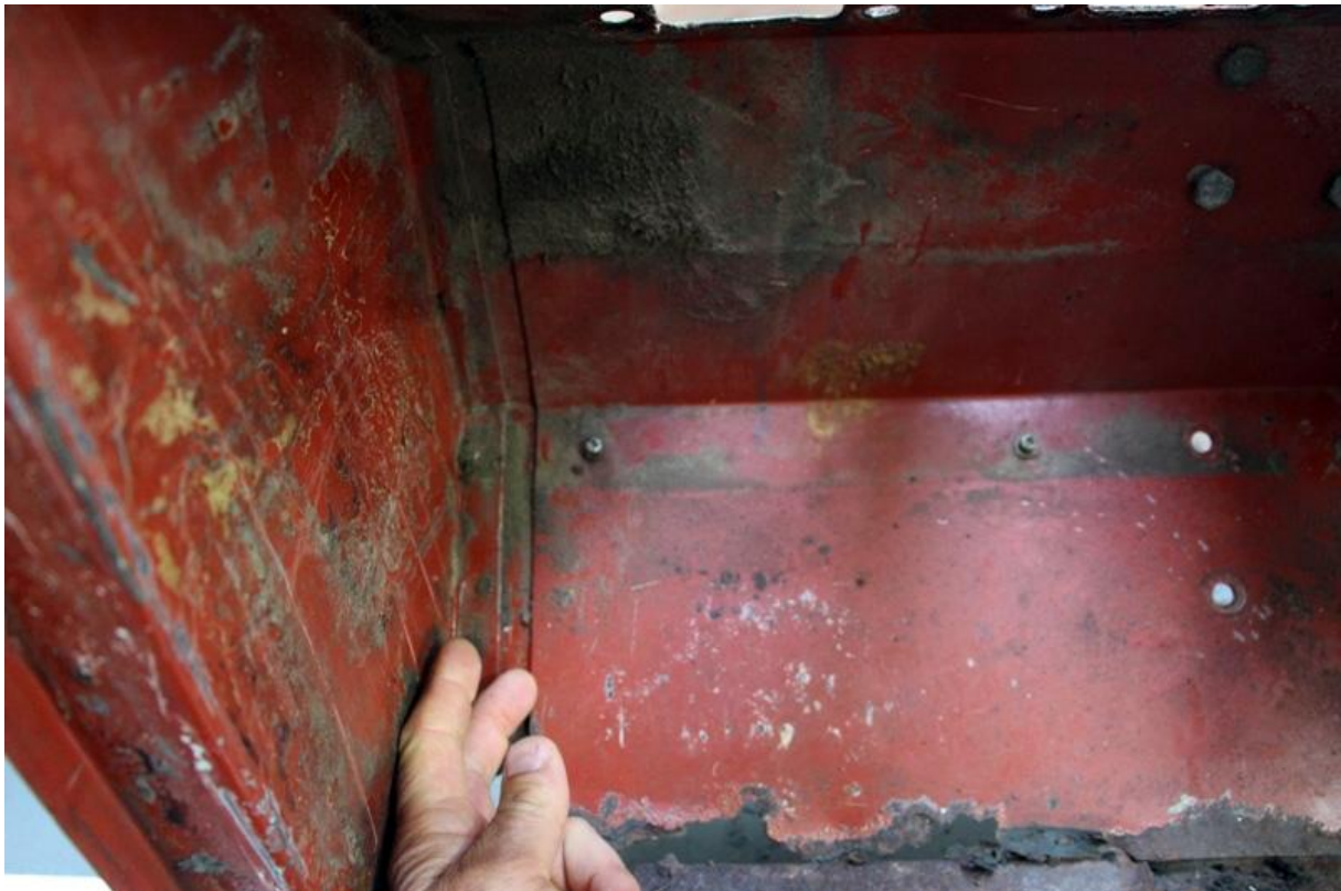
Die Unterkanten der Spritzwand sind meistens vom Rost befallen.
