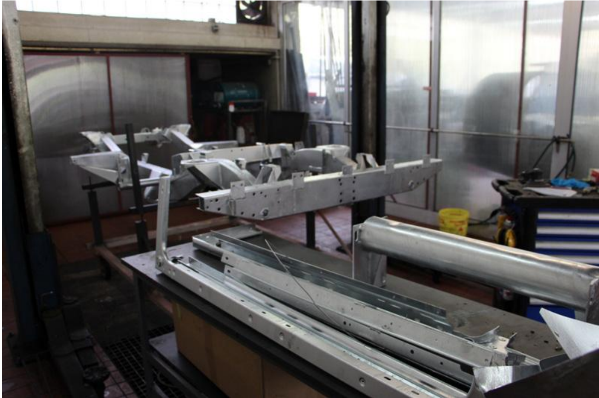
Die Innenkotflügel sowie die Zinkleisten wurden neu verzinkt.
