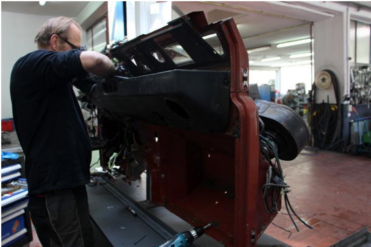
Auch am Boden der Karosse haben wir es mit Alukorrosion zu tun.
