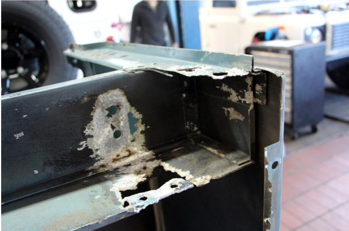
Das sind die Stellen auf die ein jeder Landrover Fahrer verzichten kann, Alukorrosion an der Heckwanne.
